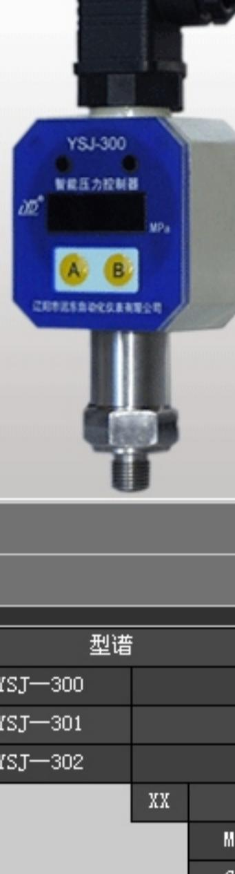
YSJ-300系列智能压力控制器，是超小型压力控制仪表，现场显示压力值，并在全量程范围内任意设定压力值。报警时输出高电平信号(+24V)，同时输出4~20mA标准信号，可根据用户要求，组合输出形式。
