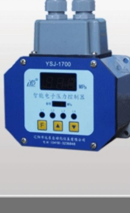
YSJ-1700型智能电子压力控制器，采用继电器接点输出型式，有4路控制功能。每一路在全量程范围内，随意设定。4路之间相互独立，同时可输出4~20mA标准信号，用户可自行选用。
